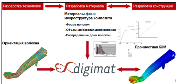
Рис. 3. Процесс многоуровневого моделирования с использованием интерфейса Digimat-CAE в производстве изделий из армированных пластмасс
